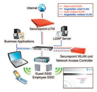
Der eingehende und ausgehende Datenverkehr läuft über die Securepoint Network Access Controller, um die Daten- und Kommunikationssicherheit zu gewährleisten, LAN-Integration zu vereinfachen und die Verwaltung zu erleichtern. Die NAC erkennt die Einstellungen von mobilen Geräten selbstständig. Die Nutzer müssen die mobilen Geräte nicht umkonfigurieren und Ihr Personal um Hilfe bitten! Der Network Access Controller ist je nach Modell in der Lage, tausende Benutzer gleichzeitig zu handhaben.
